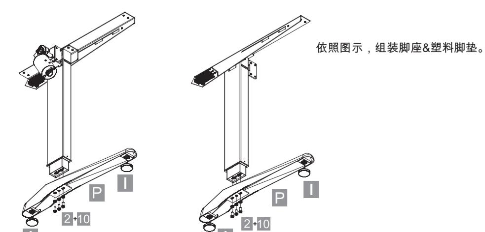
依照图示，组装脚座&塑料脚垫。
