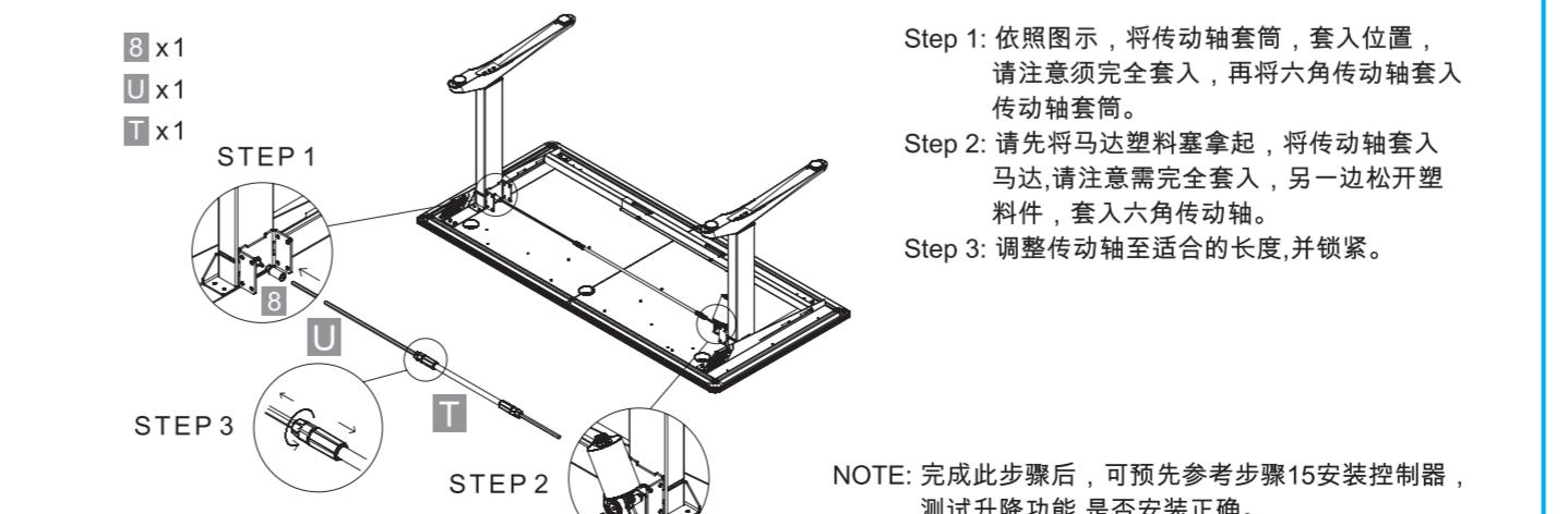
Step 1: 依照图示，将传动轴套筒，套入位置，
