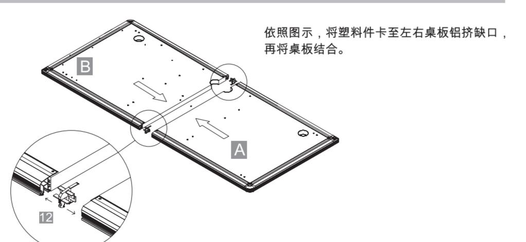
依照图示，将塑料件卡至左右桌板铝挤缺口，再将桌板结合。
